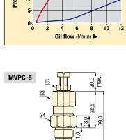
Sealing edge ø 24,0 <sup>+0,1</sup><sub>-0.0</sub> 14,0 -M20x1,5 ø 24,0 <sup>+0,5</sup>
